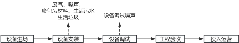
图 2-4 项目施工期工艺流程及产污环节图
